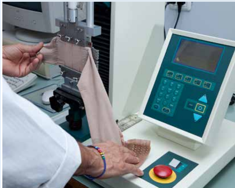
Misurazione della compressione con dinamometro
